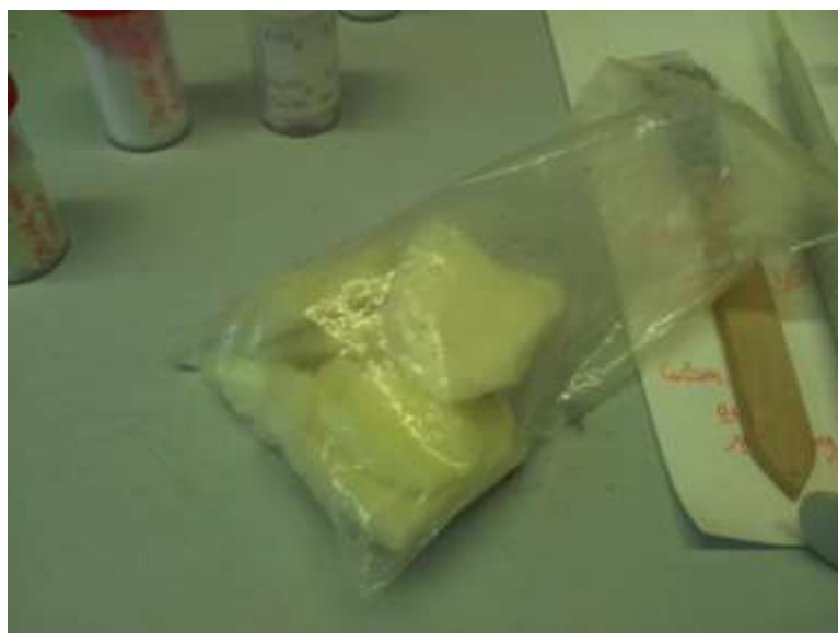
Figura 14. Campione preso dal sistema sperimentale di circolazione dei sali fusi a caldo “MOSE”
