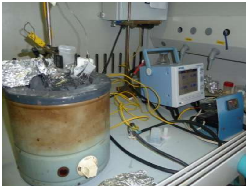
Figura 16. Foto del sistema sperimentale allestito per verificare e confrontare la stabilità delle miscele di sali
