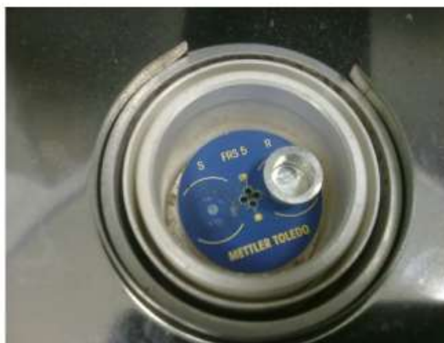
Figura 3. Dettaglio del fornello che mostra l'alloggiamento per il riferimento (a destra) e del campione (a sinistra)
